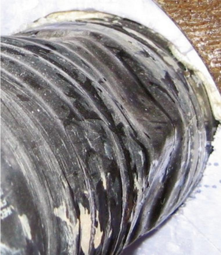
Abbildung 86, Mantelrohrdeformation durch falsche Auswahl der Ringraumdichtung
