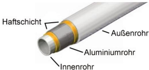
Die Struktur des Metallkunststoffverbundrohrsystem "Alu Pex".
