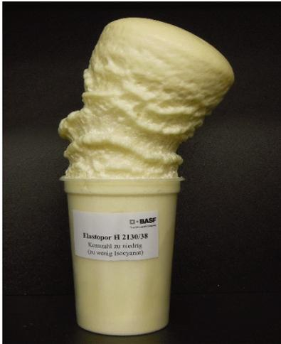
Ein Überschuss an Polyol führt zu einer weichen Schaumstruktur und zu einer deutlich geringeren Rohdichte. Diese wird verursacht durch die zu hohe Treibmittelmenge, die über den Polyolanteil zugegeben wird. Am Schaumbecher in Abb. 59 erkennt man den deutlichen Einfluss auf die Schaumqualität. Auch hier kann es, wie bei zu hohen Temperaturen (s.o.), zu einer Überfüllung und dem Aufplatzen der Muffe kommen.
