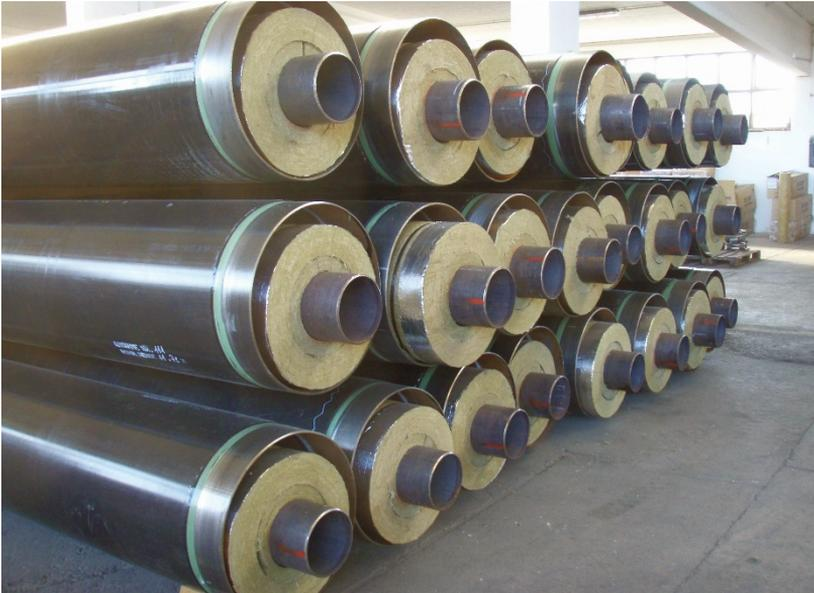
Abbildung 96, Stahlmantelrohre
