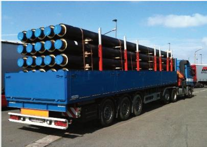
Die Lagerung der Rohrstangen auf dem LKW hat mit ausreichend breiten Holz-zwischenlagen zu erfolgen und gewährleistet somit ein sicheres und beschädigungs-freies Abladen.
