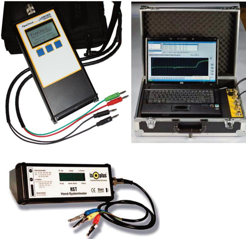
Abbildung 47, Messgeräte zur manuellen Überwachung
